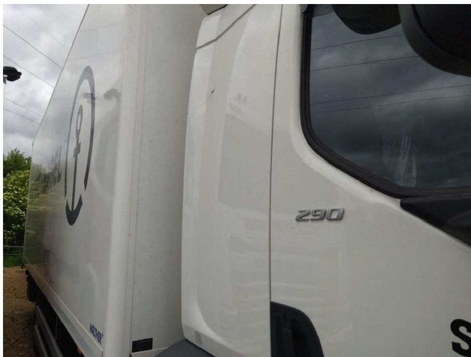
Bild 19 Seitenteil Fahrerhaus rechts verschrammt
