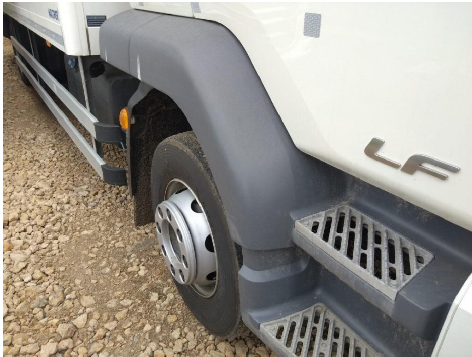
Bild 17 Einstiegskasten rechts oben verschrammt
