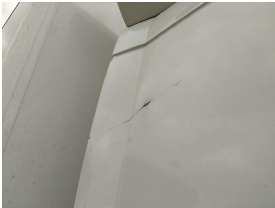
Bild 20 Seitenteil Fahrerhaus rechts verschrammt
