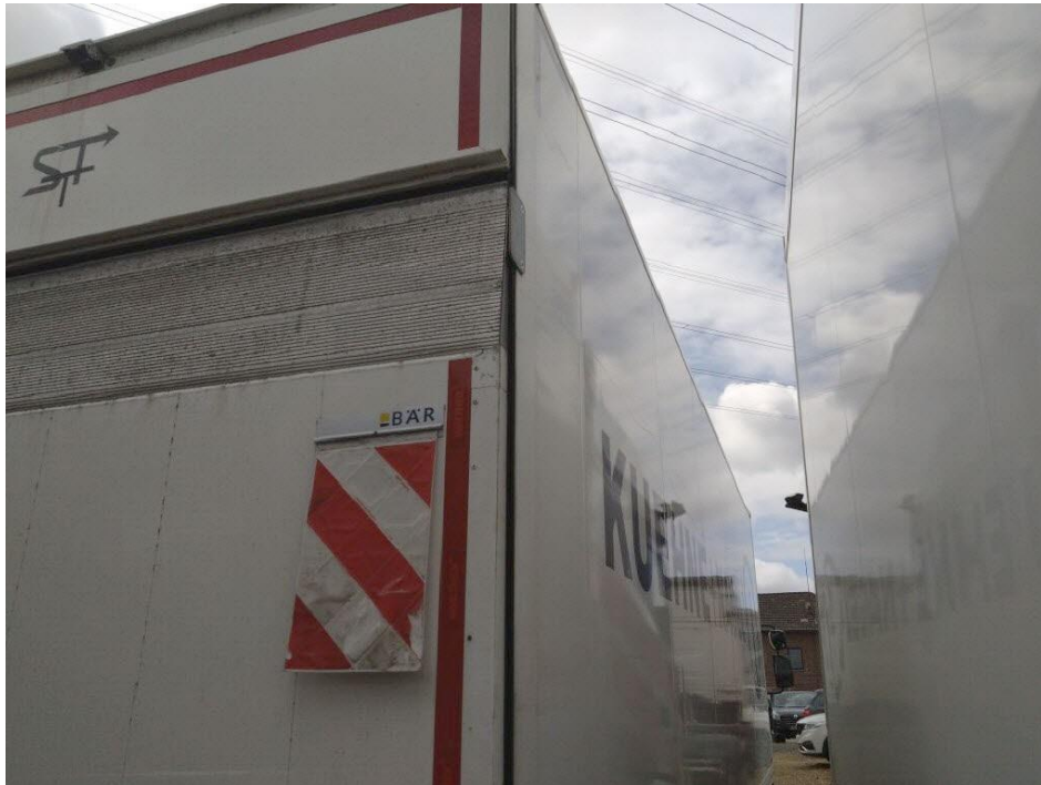
Bild 23 Seitenwand Trockenfrachtkoffer rechts verschrammt
