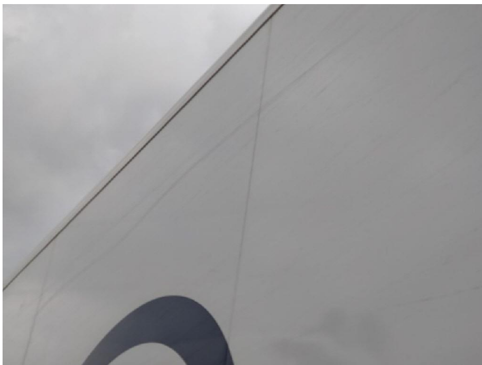
Bild 22 Seitenwand Trockenfrachtkoffer rechts verschrammt
