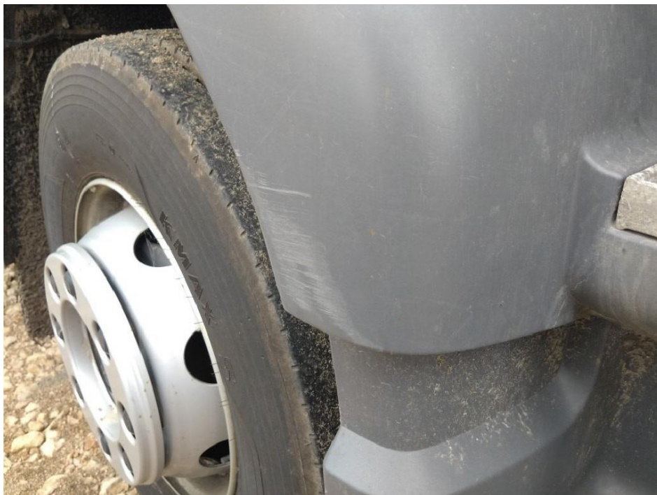
Bild 18 Einstiegskasten rechts oben verschrammt
